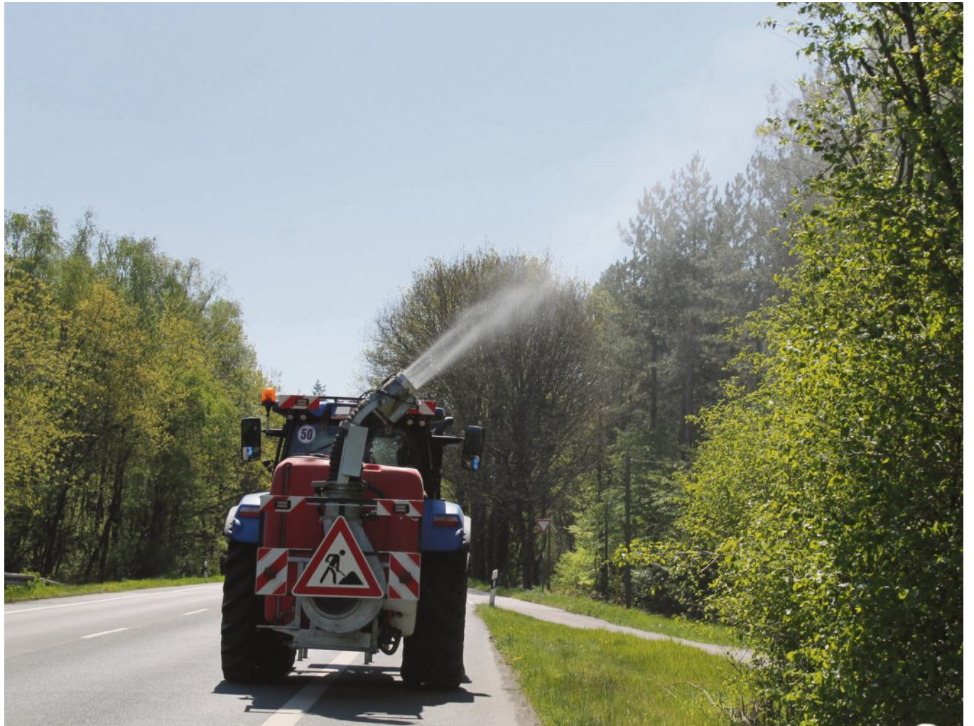
Das Biozid wurde mit einer Turbinenspritze versprüht.
